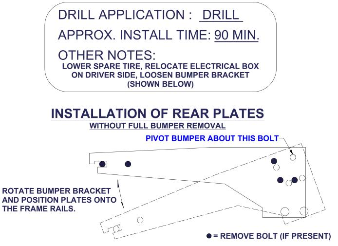
ROTATE BUMPER BRACKETS BACK INTO POSITION AND INSTALL AS SHOWN BELOW
